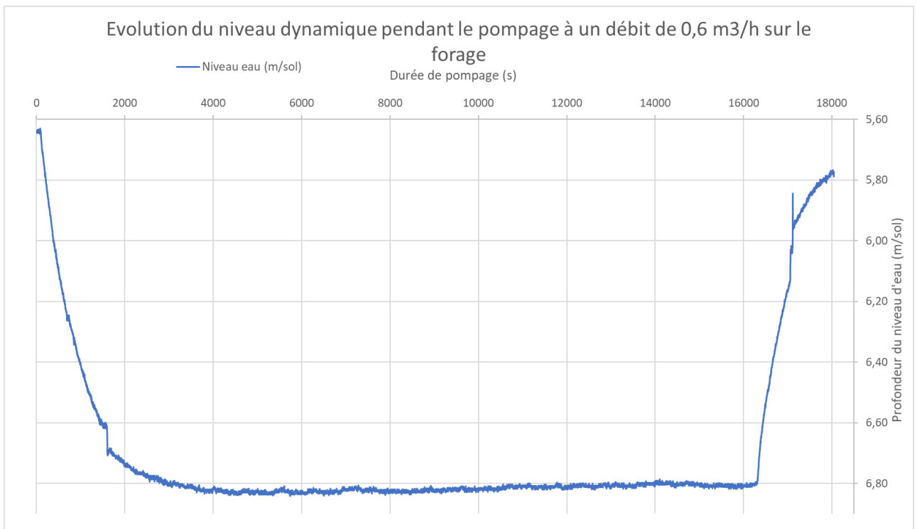
Figure 16 : Hydrogramme du forage obtenu lors du pompage du 22 février 2022 au débit de 0,6 m 3 /h - suivi automatique
